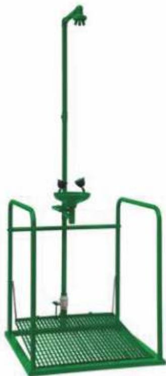
Stazione di decontaminazione con doccia e lavaocchi. Installazione a pavimento. Tubi in acciaio zincato, raccordi in ottone, base e pedali in alluminio, verniciatura epossidica anticorrosiva. Lavaocchi con vaschette in ABS, spruzzo aerato e regolato.
